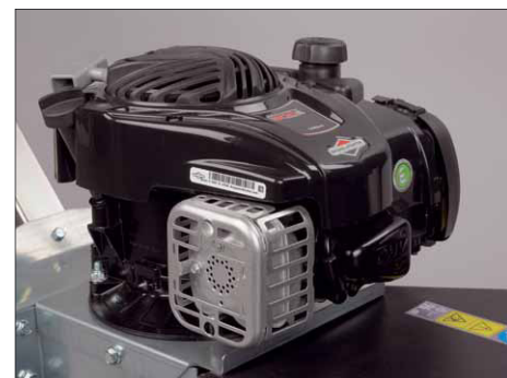
Zum Antrieb der Bürste dient ein solider Briggs & Stratton-500-E-Motor mit 140 cm 3
